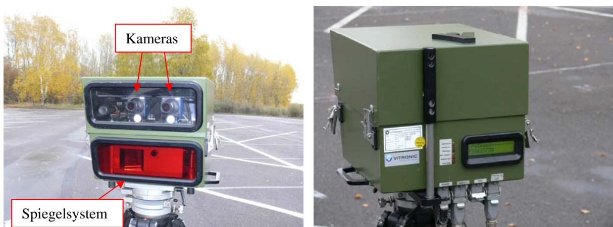
Abbildung 2: Messeinheit des Messsystems PoliScan speed
